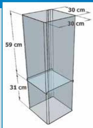
Bac soldeur en polycarbonate incassable de 30 x 30 et hauteur 90 cm avec une tablette à 30 ou 60 cm du haut en fonction du sens dans lequel on le pose au sol.
